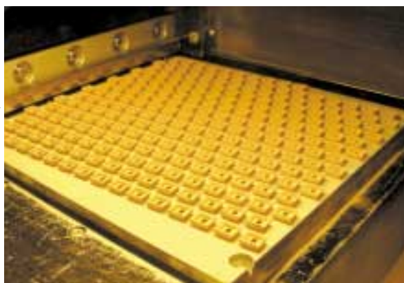
Metallische Funktionsteile in der EOSINT M 250 Xtended Maschine. Foto: Alphaform RPI/ EOS GmbH
