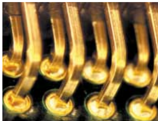
Durchstieg an einer Stiftleiste in Abhängigkeit vom Innenlagenkupfer. Foto: FhG-ISIT
