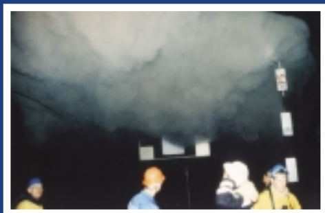
Rauchverteilung gegenüber dem Hauptbelüftungsstrom bei einem Eisenbahnbrand
